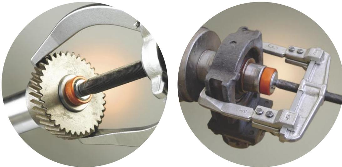
Mit c-pro<sup>®</sup>, der cleveren Schweizer Erfindung, lassen sich Kugellager, Büchsen, Riemenscheiben und Zahnräder einfach, sicher und ohne Beschädigung abziehen. Die Rückseite haftet magnetisch am Wellenende. Auf dem drehbaren Kern mit Zentrumsbohrung auf der Vorderseite sitzt die Spindel sicher und lässt sich mühelos drehen.
