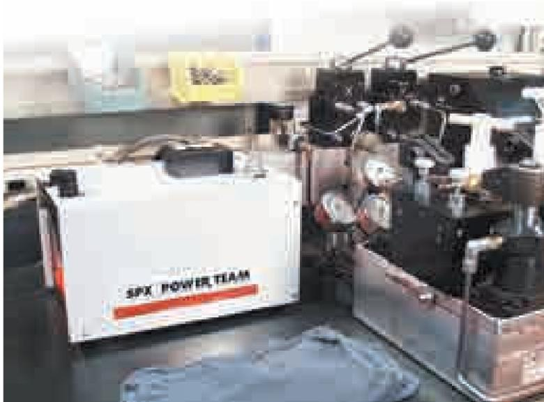
Die PA60-Pumpe beim Einsatz in einer Spannvorrichtung.
