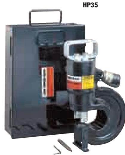
**Nr. HP35SP** – Stanzensatz mit Pumpe. Mit Hydraulikstanze HP35, Elektro-Hydraulikpumpe PE172, Schlauch Nr. 9756, Schlauch-Kupplungshälfte Nr. 9798, Stempel- und Matrizensatz Nr. 250459 und Metallkoffer. Gewicht 40 kg. HINWEIS: Für 220 V, 50 Hz. bei der Bestellung „-220“ zur Bestell-Nr. hinzufügen.
