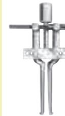
**Innenabzieher** haben schmale Backen, die mittig durch das abzuziehende Teil geschoben werden. So wird die Zugkraft senkrecht ausgeübt und das Gehäuse wird nicht beschädigt. Die Backen sind verstellbar, so dass sie an den jeweiligen Durchmesser des abzuziehenden Teils angepasst werden können (siehe Seite 204).
