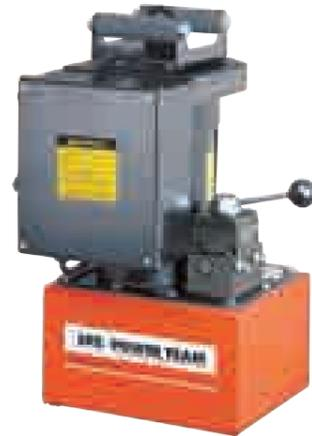
**PE60** - Die Vanguard® Supreme®-Pumpen garantieren störungsfreien Betrieb auch unter den härtesten Einsatzbedingungen. Mit Einphasenmotor (0,82 kW, 1 1/8 PS) und mäßigem Geräuschpegel zwischen 80 und 85 dBA. Problemloser Anlauf unter Volllast, selbst bei reduzierter Spannung (z.B. auf Baustellen). Pumpen mit hoher Förderleistung, ideal für den Einsatz mit Spannsystemen und anderen Hochdruck-Hydraulikwerkzeugen. Siehe Seiten 96 bis 97.
