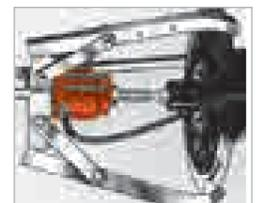
Ein 3-armiger Abzieher sorgt für sicheren Halt. Die hydraulische Handpumpe liefert die Kraft zum Herausdrücken einer Welle aus dem Gehäuse. Ein Wellenschutz am Spindelende schützt die Welle.
