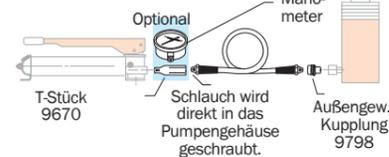
Anschluss System mit einfachwirkender Druckluftpumpe
