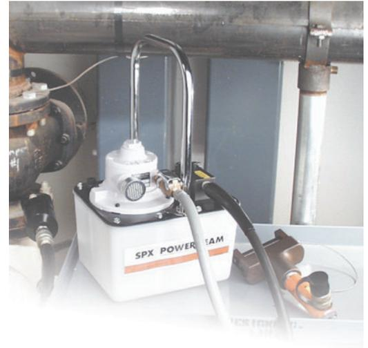
PA17-Pumpe im Einsatz mit einem Flanschspreizer.
