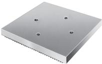
**Zylinder-Bodenstück aus Aluminium** – Für Anwendungen, bei denen ein größeres Zylinder-Bodenstück erforderlich oder vorteilhaft ist. Wird mit vier 3/8-Zoll-16 Schrauben (inbegriffen) am Boden der Zylinder RA556, RA556L und RA5510 befestigt. Geriffeltes Bodenstück für zusätzliche Stabilität.
